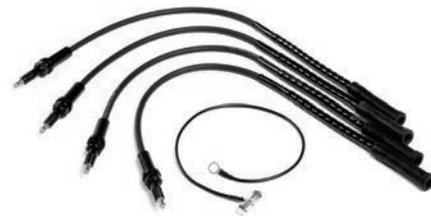
Este conjunto de cables de conexión es ideal para los paquetes Multi COP. Solo necesita fijar un cable entre cada paquete de la bobina y el enchufe, coloque una toma de encendido secundario MI074 para cada derivación, y su osciloscopio muestran las formas de onda de encendido precisas con mediciones kV correctas.
